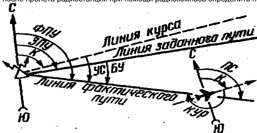
Рис. 8. Определение УС и ФПУ при помощи радиокompаса.
